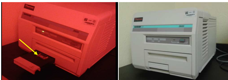
Figura 3.2 Equipo Harshaw 3500 TLD, la flecha indica posición de la plancheta de calentamiento para las muestras.
