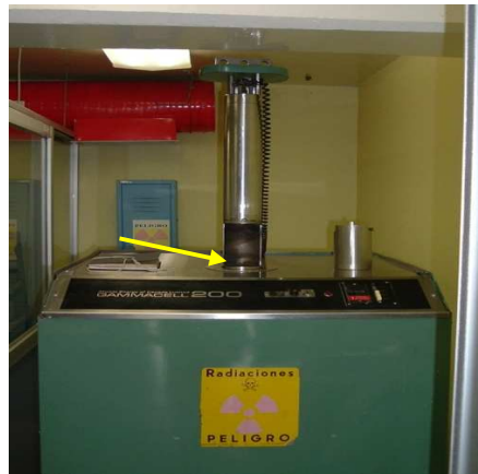
Figura 3.1 Irradiador Gammacell-200 con fuente de ^{60}\text{Co} , la flecha indica el sitio de colocación de las muestras.
