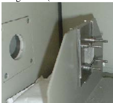
Figura 3.4: Montaje de las ventanas de NaCl con el estándar de isoniazida por técnica de suspensión.
