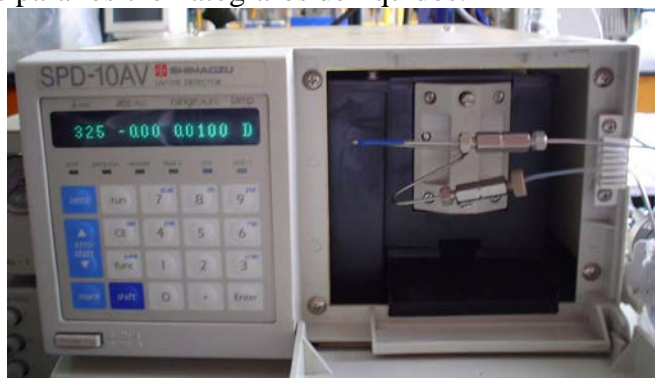
Figura 2.18: Detector UV-Vis de longitud de onda variable marca Shimadzu de longitud de onda variable utilizado en este trabajo.
