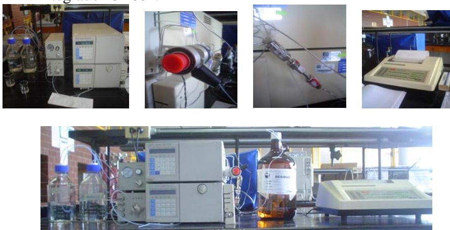
Figura 3.6: Cromatógrafo de líquidos de alta eficiencia modular marca Shimadzu.
