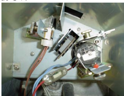
Figura 2.9: Lámparas de Tungsteno y Deuterio.
