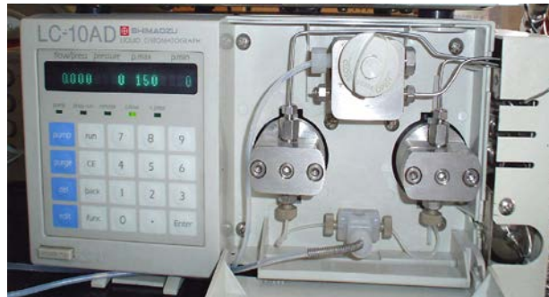
Figura 2.15: Bombas reciprocantes de un equipo marca Shimadzu.
