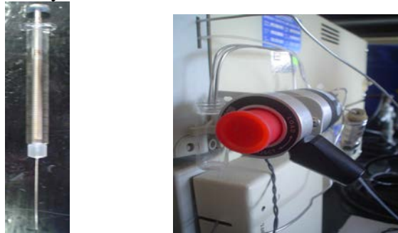
Figura 2.16: Jeringa y Válvula de Inyección.
