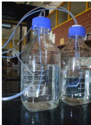
Figura 2.14: Contenedores de vidrio para la fase móvil.
