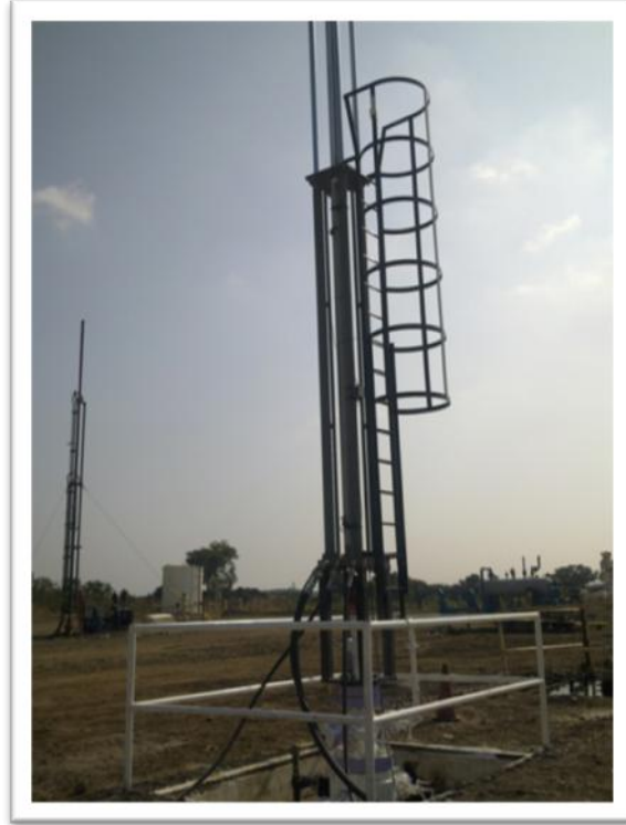
Figura II-15 Unidad Morlift de bombeo mecánico.
