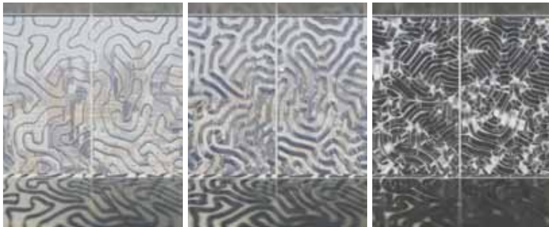
Img. 44. Fachada homeostática. Por medio de un sistema electromecánico una doble envolvente sensible a los cambios climáticos permite regular las condiciones ambientales al interior del edificio. Decker Yeadon Projects, 2010.
