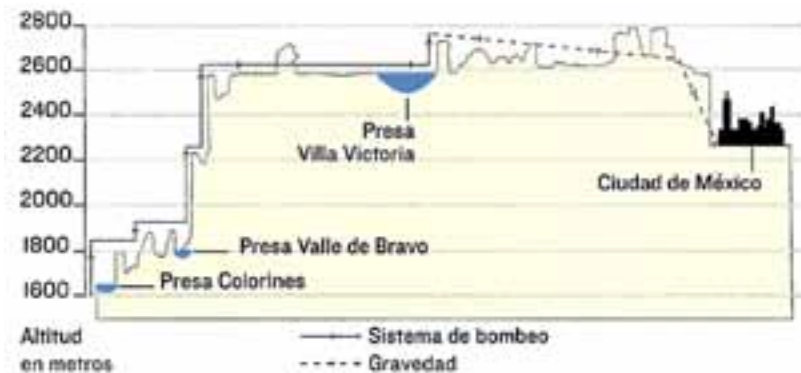
Img. 15. Perfil de bombeo y conducción del sistema Cutzamala.
