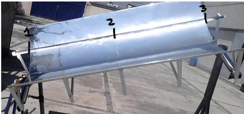
Figura. 4.19.-Cocentrador dividido en tres secciones de medición.
