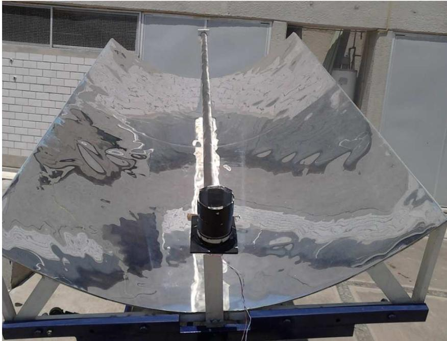
Figura. 3.2.- Concentrador solar cilíndrico parabólico posicionado de tal forma que los rayos están dirigidos al foco
