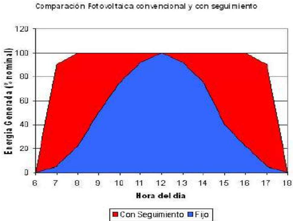
Figura. 3.4.-Comparacion de una celda fija y con seguimiento
