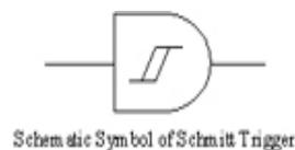
Figura. 4.7.- Imagen del Schmitt trigger CD4093 y su símbolo eléctrico
