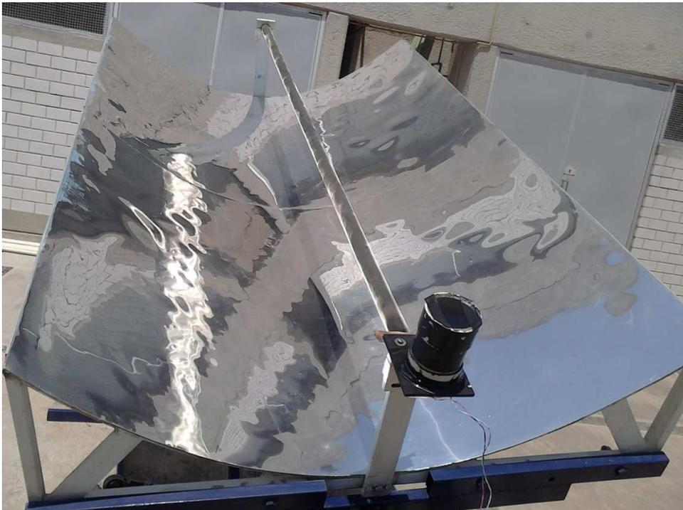
Figura. 4.18.-Concentrador con sensores ubicados en medio
