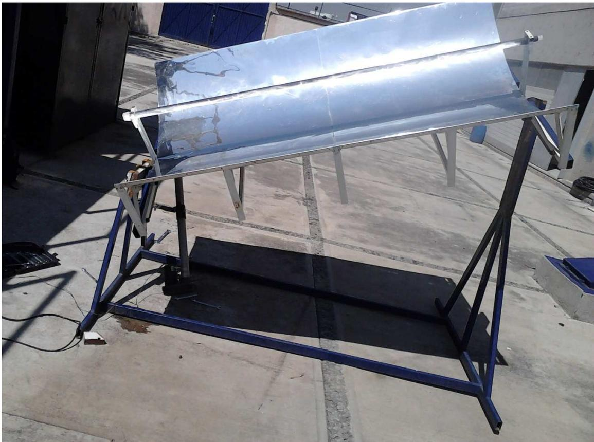
Figura. 2.11.- Concentrador cilíndrico parabólico
