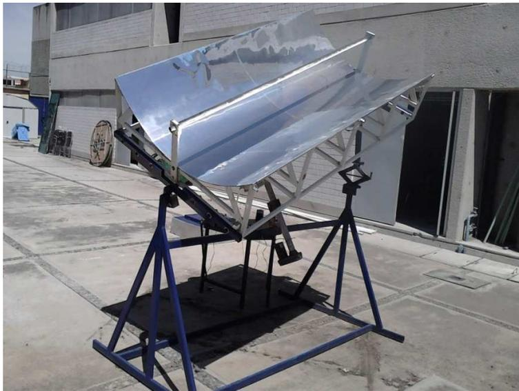
Figura. 3.1.- Concentrador solar cilindro
