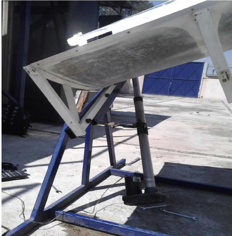
Figura. 3.3.-Mecanismo del concentrador cilíndrico parabólico
