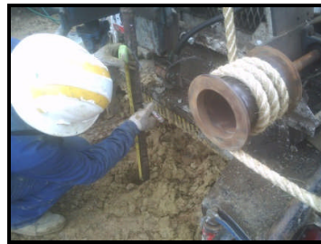
FOTOGRAFÍAS No. 5 Y No. 5-A Marcado de tubo de media caña para la determinación del número "N" de golpes.
