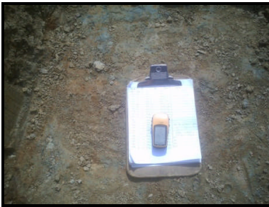
FOTOGRAFÍAS No. 2 Localización de los sondeos mediante obtención de coordenadas absolutas, con un dispositivo de posicionamiento global (GPS).
