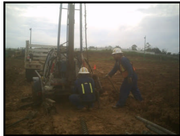
FOTOGRAFÍAS No. 5 Y No. 5-A Marcado de tubo de media caña para la determinación del número "N" de golpes.
