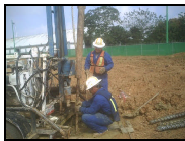
FOTOGRAFÍAS No. 6 Y No. 6-A Determinación de del número "N" de golpes mediante la prueba de penetración estándar (SPT-ASTM-D-1586-VIGENTE)
