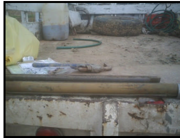
FOTOGRAFÍAS No. 7 Y No 7-A Recuperación de muestras contenidas en el muestreador de media caña (tubo partido).
