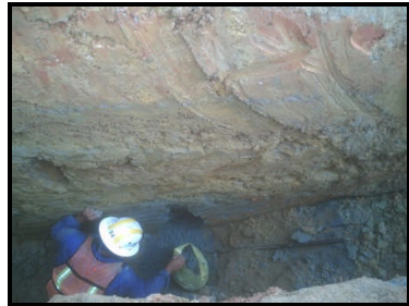
FOTOGRAFÍAS No. 9 Y No 9-A Obtención de muestras alteradas en sondeos tipo pozo a cielo abierto Y determinación de espesores.
