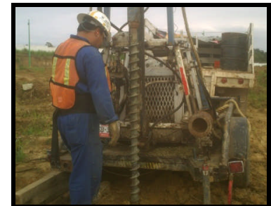
FOTOGRAFÍAS No. 4 Y No. 4-A. Exploración del sitio, mediante la utilización de barrenas helicoidales solidas con equipo mobil dril B-24.
