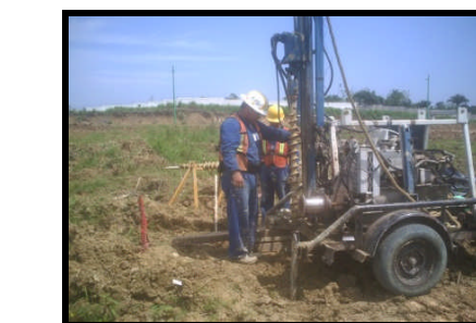
FOTOGRAFÍAS No. 4 Y No. 4-A. Exploración del sitio, mediante la utilización de barrenas helicoidales solidas con equipo Mobil Drill B-24.
