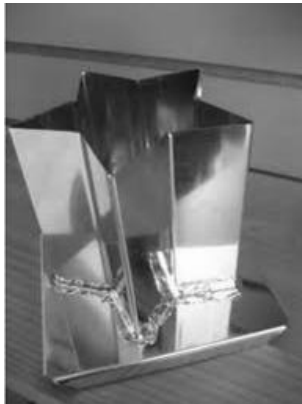
Moldes: metálico para vela de estrella y de policarbonato para esfera resiste hasta 90°C
