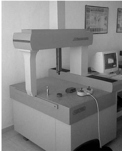
Figura 2. Máquina de medición por coordenadas.
