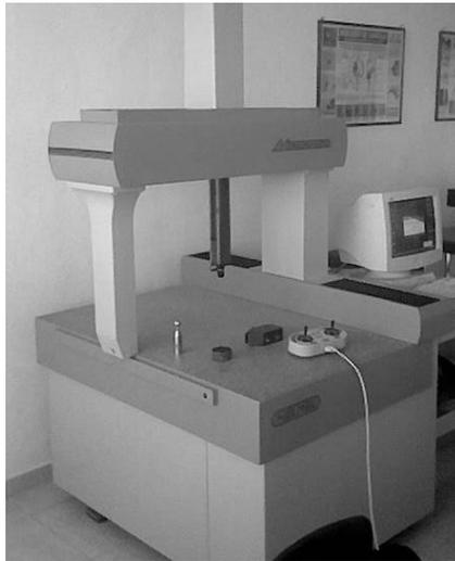
Figura 57. Máquina de Medición de Coordenadas Helmel
