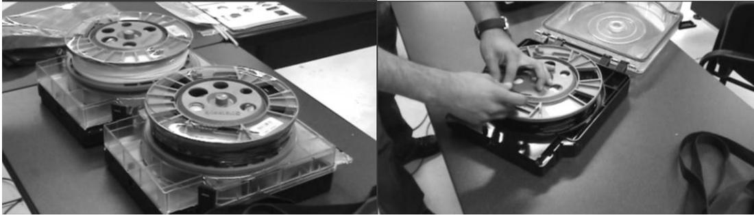
Figura 99. Preparación de carretes de impresión Modelo - Soporte
