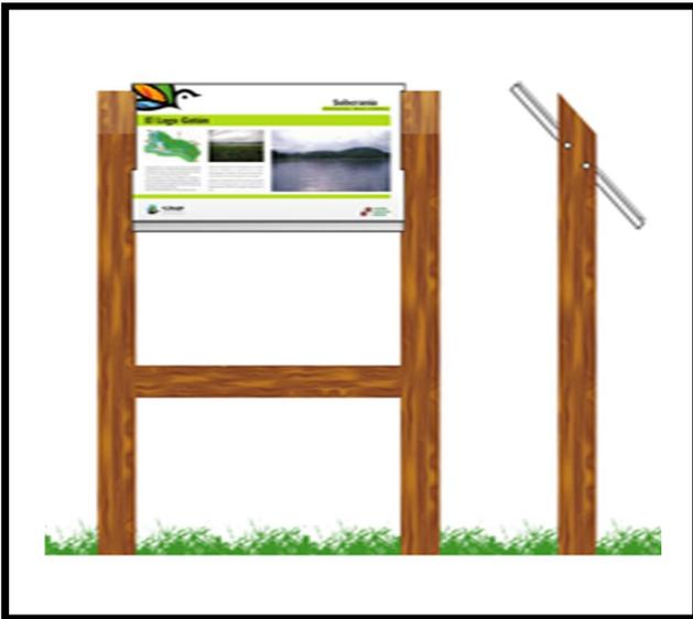
Fig. 16 Mesa de interpretación diseñada para resaltar aspectos del paisaje, geografía y ecosistemas. El diseño es a base de madera con plancha de metacrilato.
