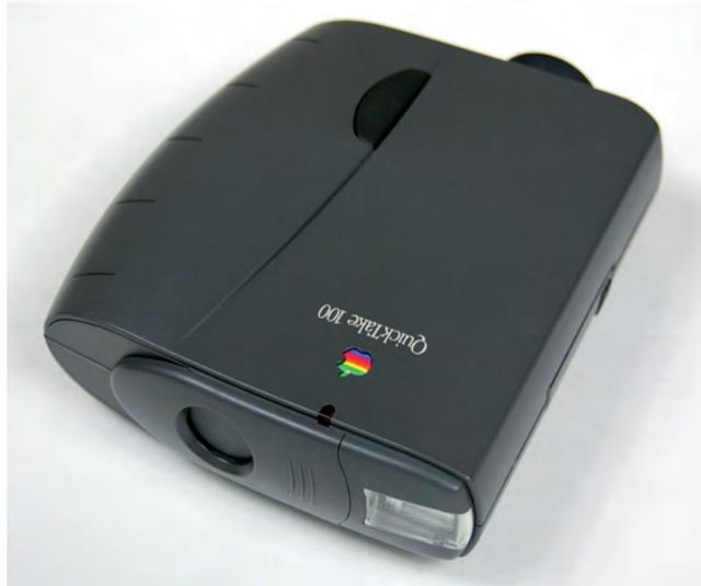
con Kodak, trabajaba con una computadora personal mediante un cable serial y tenía un sensor CCD de 640 x 480 píxeles. Podía producir ocho imágenes almacenadas en su memoria interna, y también contaba con flash integrado.”<sup>117</sup>
