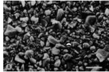
Fig. 4: Fotografía con microscopio electrónico de barrido (SEM) de partícula de microrrelleno
