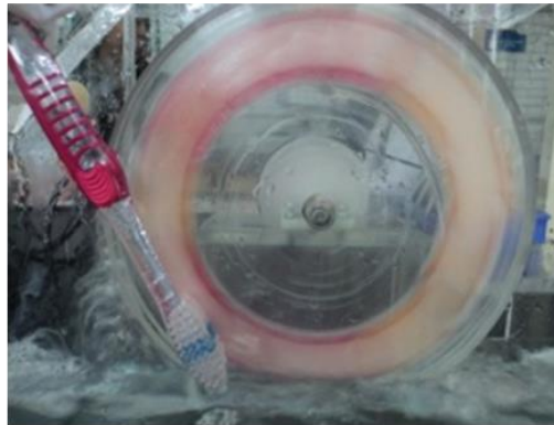
Fig.33: Equipo simulando el cepillado con agua
