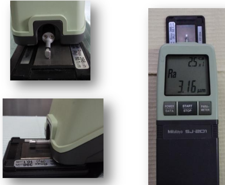
Fig. 24: Calibración del perfilómetro
