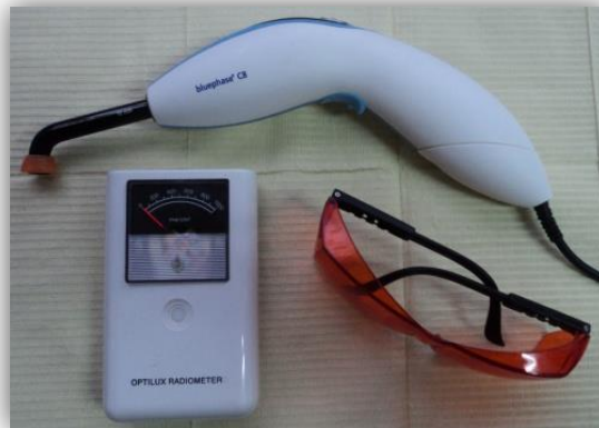
Fig. 17: Material para polimerización: lámpara, radiómetro y lentes de protección
