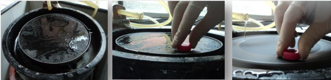
Fig. 23: pulido de la muestra con papel abrasivo
