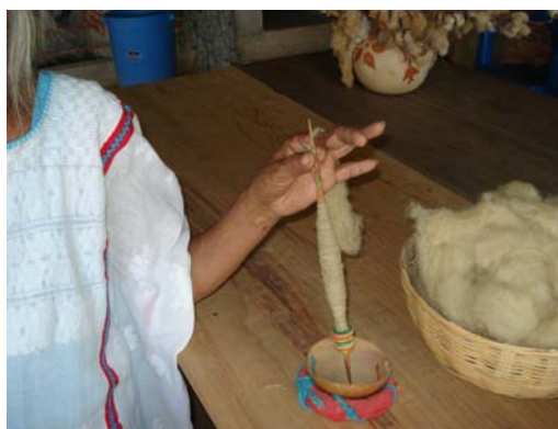
fig.97. Hila el algodón verde, muestra el huso, malacate, jícara y como base una pequeña "dona" de tela rellena de arroz para que la jícara tenga un soporte.
