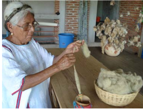
fig. 98. En la imagen inferior muestra el proceso de hilado que básicamente es estiramiento y torsión para formar hilos continuos.
