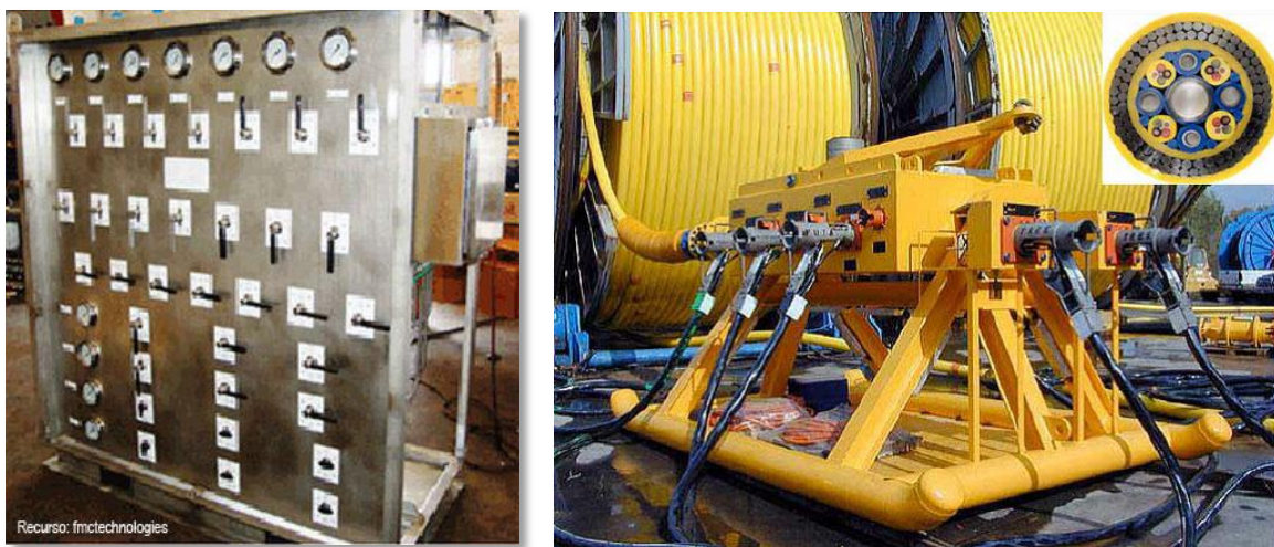
Figura 1.10 Unidad TUTA (izquierda) y unidad SUTA (derecha) junto a carretes de umbilicales
