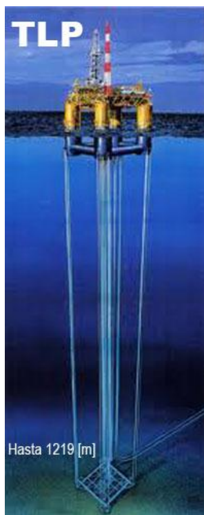
Figura 1.8 Plataforma de piernas tensionadas
