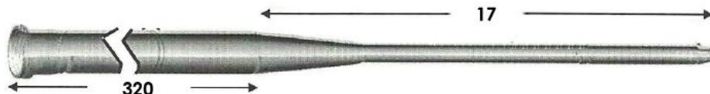
Figura 4.6 Caisson utilizado en el CPP
