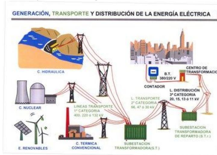
Figura 1.2 Elementos estructurales del sistema de energía eléctrica.
