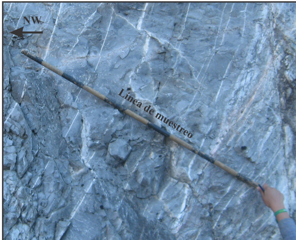
Figura 20: Metodología de muestreo en 1D para las distintas familias de vetas, en donde se utilizaron líneas de muestreo de 1 m de longitud.
