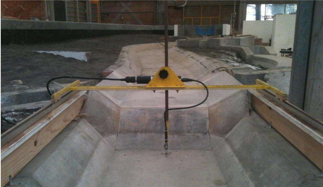
**Figura 3.4 Posicionamiento y sujeción del ADV**
