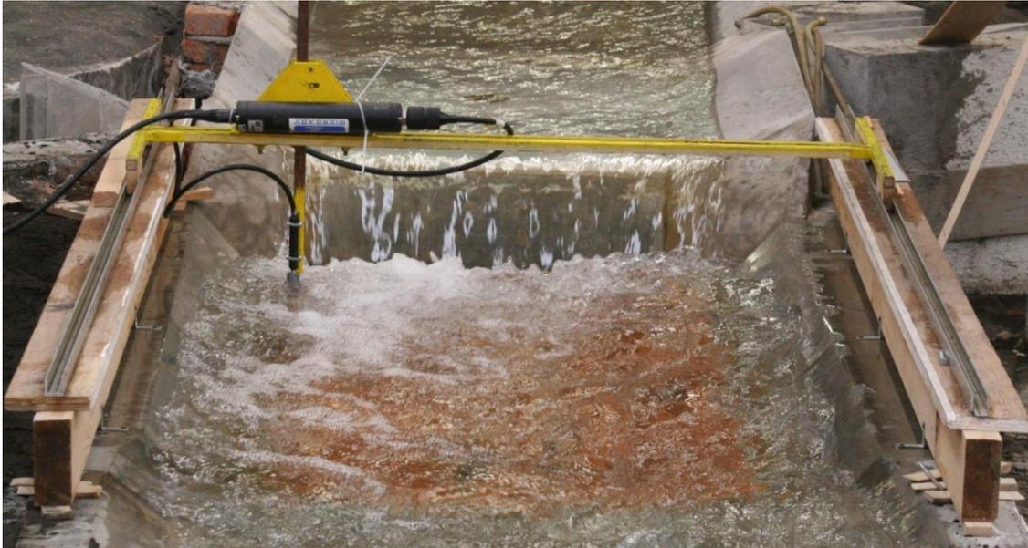
**Figura 3.5 Registro de señales de velocidad con ADV**
