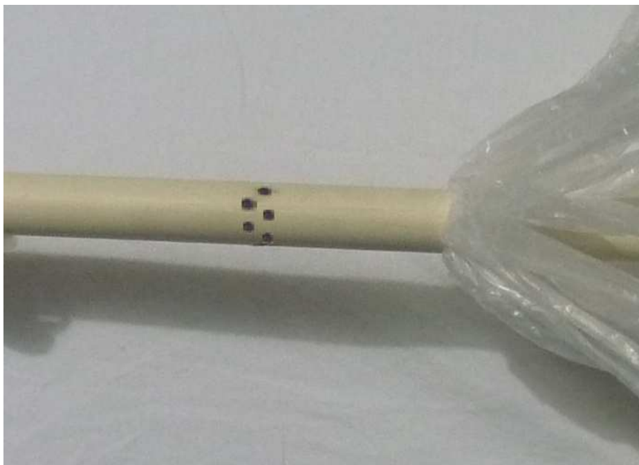
Fig. 24 Orificios de captación en el SCARN
