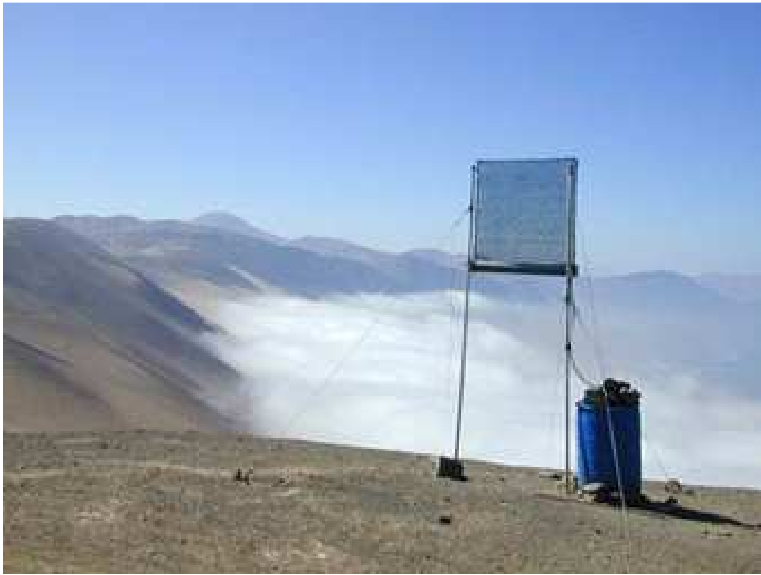
Fig. 23 Neblinometro con bote de almacenamiento
