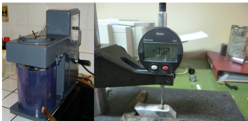
Figura 3.15: Proceso de pulido electroquímico y medición de la profundidad de la muestra
