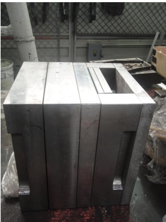
Fig. 3.4 Vista lateral portamolde.
