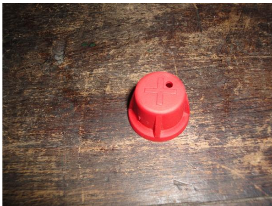
Fig. 4.18 Pieza de polipropileno, tapadera para ánodo de batería de automóvil.
