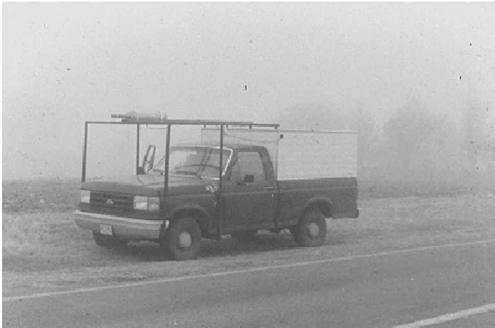
Figura 2.1. Fotografía de la camioneta en el lugar de muestreo. El FSSP puede apreciarse montado en la parte frontal superior del vehículo.
