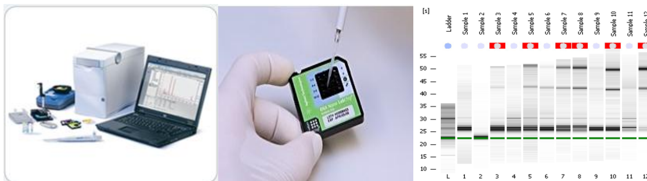
Figura 11. Plataforma Agilent 2100 Bioanalyzer; chip del Kit Agilent RNA 6000 Nano, que contiene una matriz de gel de agarosa, para verificar calidad e integridad del RNA y una imagen a manera de gel arrojada por el equipo.
