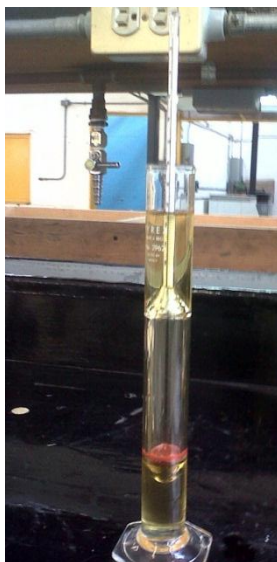
Figura 3.4. Determinación de la densidad a temperatura ambiente
