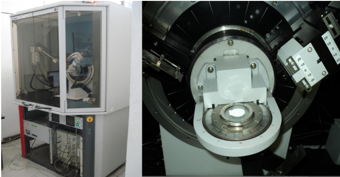
Figura 4. Difractómetro BRUKER AXS modelo D8 Advance, utilizado para identificar las fases que componen los productos de la etapa de síntesis y los obtenidos del proceso de captura.
