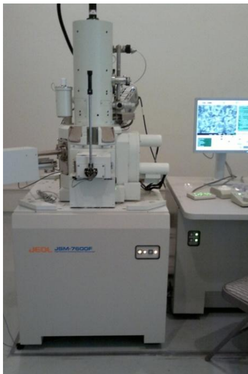
Figura 8. Equipo JEOL JMS-7600F, ocupado para determinar las características superficiales del \text{Li}_8\text{SiO}_6 antes y después del tratamiento térmico.
