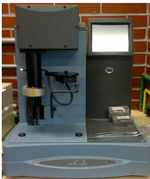
Figura 9. Termobalanza Q500HR, utilizada para determinar las propiedades de captura de \text{CO}_2 del \text{Li}_8\text{SiO}_6 .
