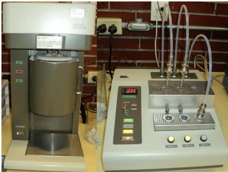
Figura 6. a) Bel-Japan modelo Minisorp II, b) Belprep-vacII, usados para realizar las mediciones de área superficial y efectuar la desgasificación del material respectivamente.
