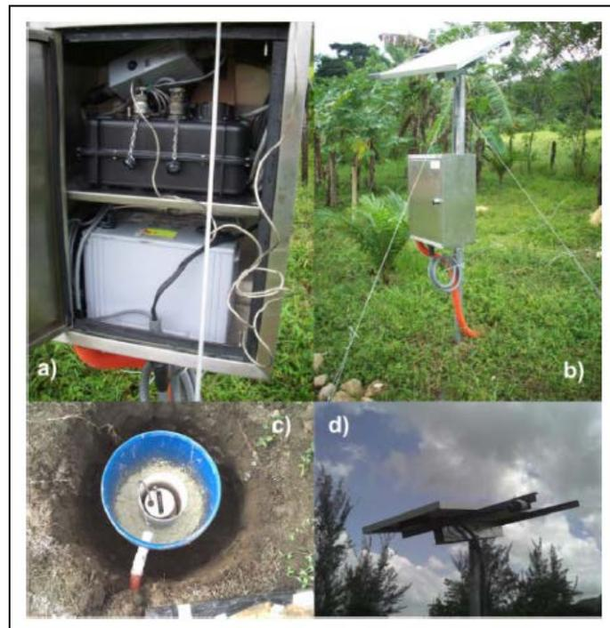
Figura 2.3. Instalación de la estación sismológica temporal. a) Gabinete con el controlador de carga, el digitalizador, le controlador del sensor y la batería. b) Soporte con el gabinete y el panel solar. c) Interior del barril con el sensor. d) Panel solar y receptor GPS. Tomada de Melgar Moctezuma (2009).
