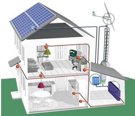
Figura 2.25 Sistemas híbridos eólicos-solares
