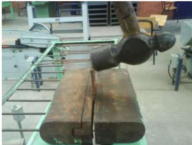
Figura 5.35 Realizando la prueba de resistencia de la soldadura
