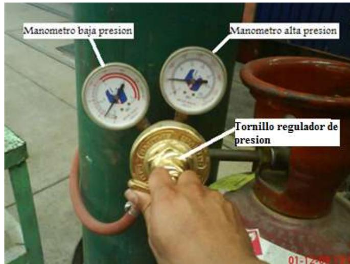
Figura 6.15 Calibrando los manómetros de gas acetileno
