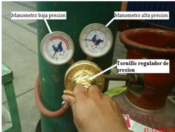
Figura 5.15 Calibrando los manómetros de gas acetileno
