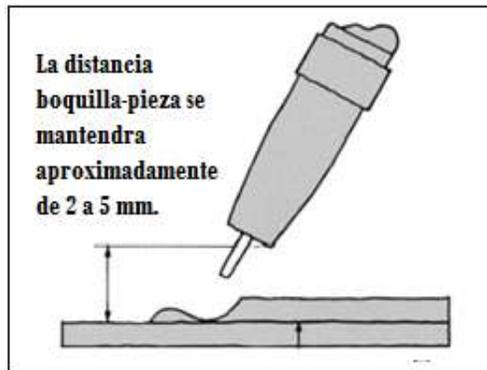
Figura 5.28 Distancia entre boquilla y pieza para soldar
