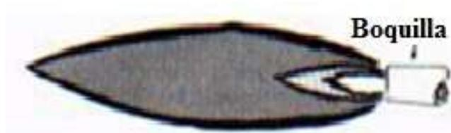
Figura 5.25 Flama carburizante o con exceso de acetileno
