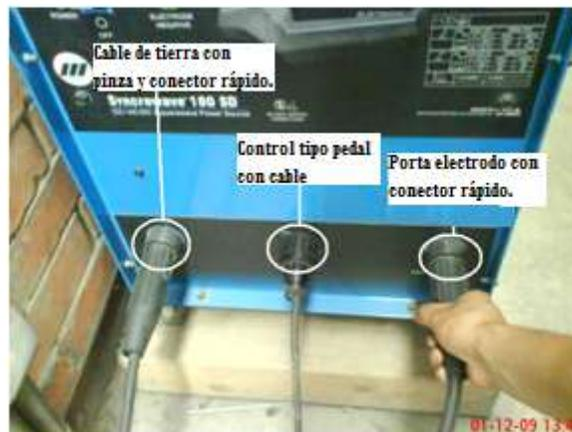
Figura 4.14 Conexión de aditamentos a la maquina SYNCROWAVE 180 SD
