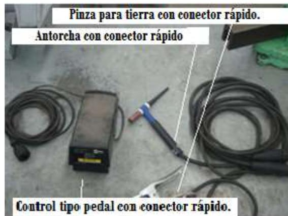
Figura 4.6 La antorcha de soldadura
