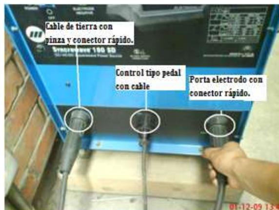
Figura 6.18 Conexión de aditamentos a la maquina SYNCROWAVE 180 SD
