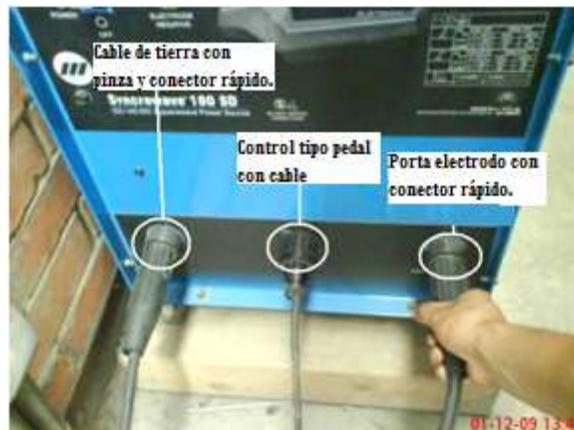
Figura 5.18 Conexión de aditamentos a la maquina SYNCROWAVE 180 SD
