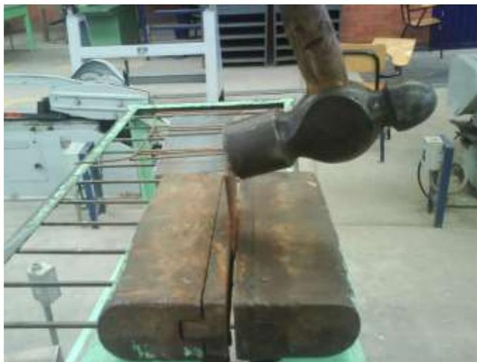
Figura 4.26 Realizando la prueba de resistencia de la soldadura
