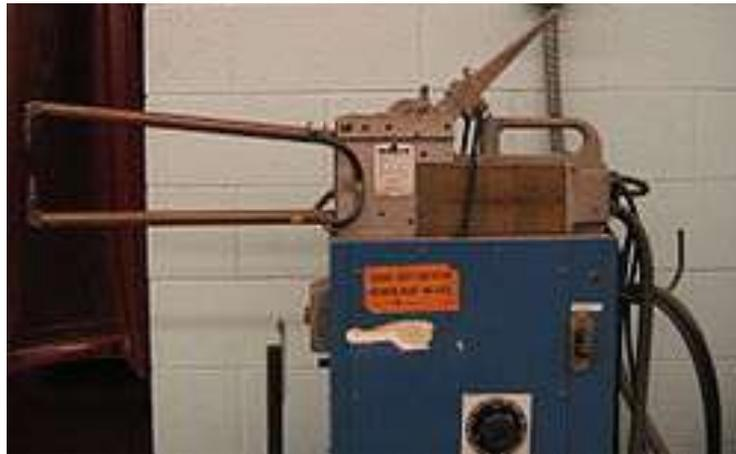
Figura 1.3 Equipo de soldadura por resistencia
