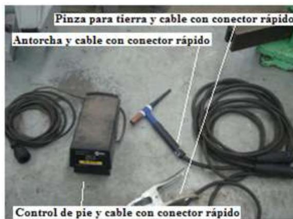
Figura 6.6 Se observa la antorcha del equipo
