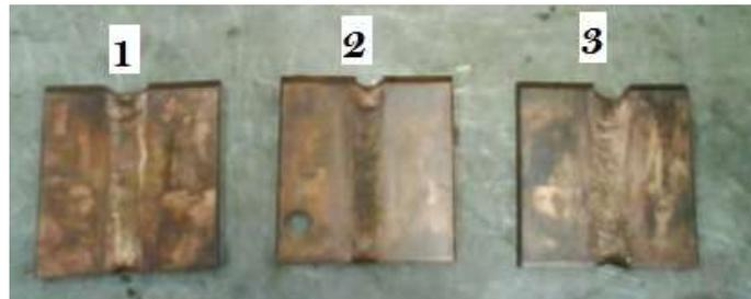
Para la muestra soldada a tope #1, que se realiza con una temperatura de 300 °C y un amperaje de 160 amperes, se observa un cordón de buena apariencia y uniforme, la penetración es buena, no presenta deformación ni porosidad, no se observa deformidad en las placas y al realizarse la prueba de resistividad no presenta desviación al impacto del martillo.
