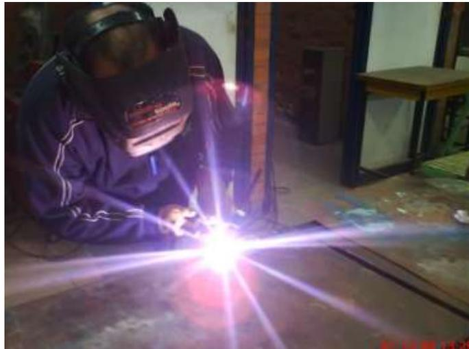
Figura 5.31 Soldando las placas de cobre
