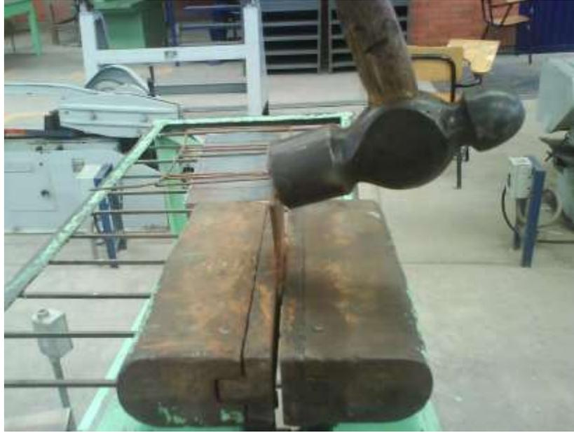
Figura 6.35 Realizando la prueba de resistencia de la soldadura
