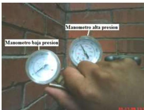
Figura 4.11 Calibrando los manómetros de gas argón
