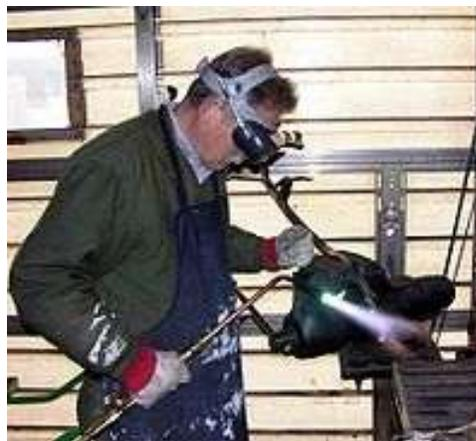
Figura 1.2 Soldadura a gas de una armadura de acero usando el proceso de oxiacetilénica.
