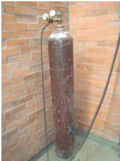
Figura 4.10 Tanque de gas argón
