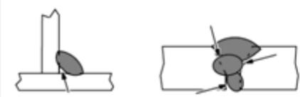
**Fusión incompleta - El metal de soldadura no se fusiona completamente con el metal base o un cordón de soldadura anterior**
