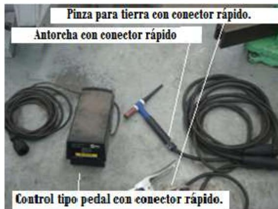
Figura 5.6 La antorcha de soldadura
