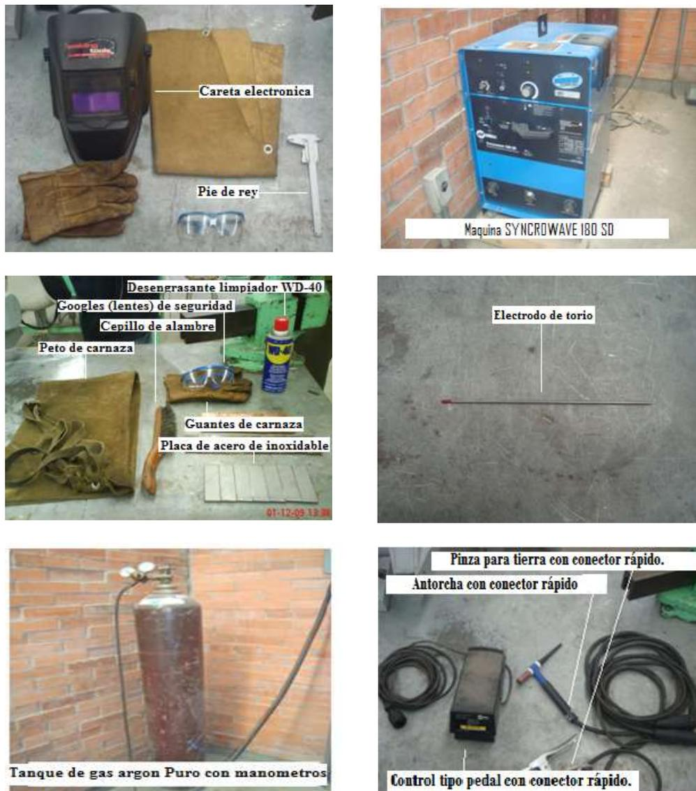
Figura 4.2 Elementos para soldadura TIG.
