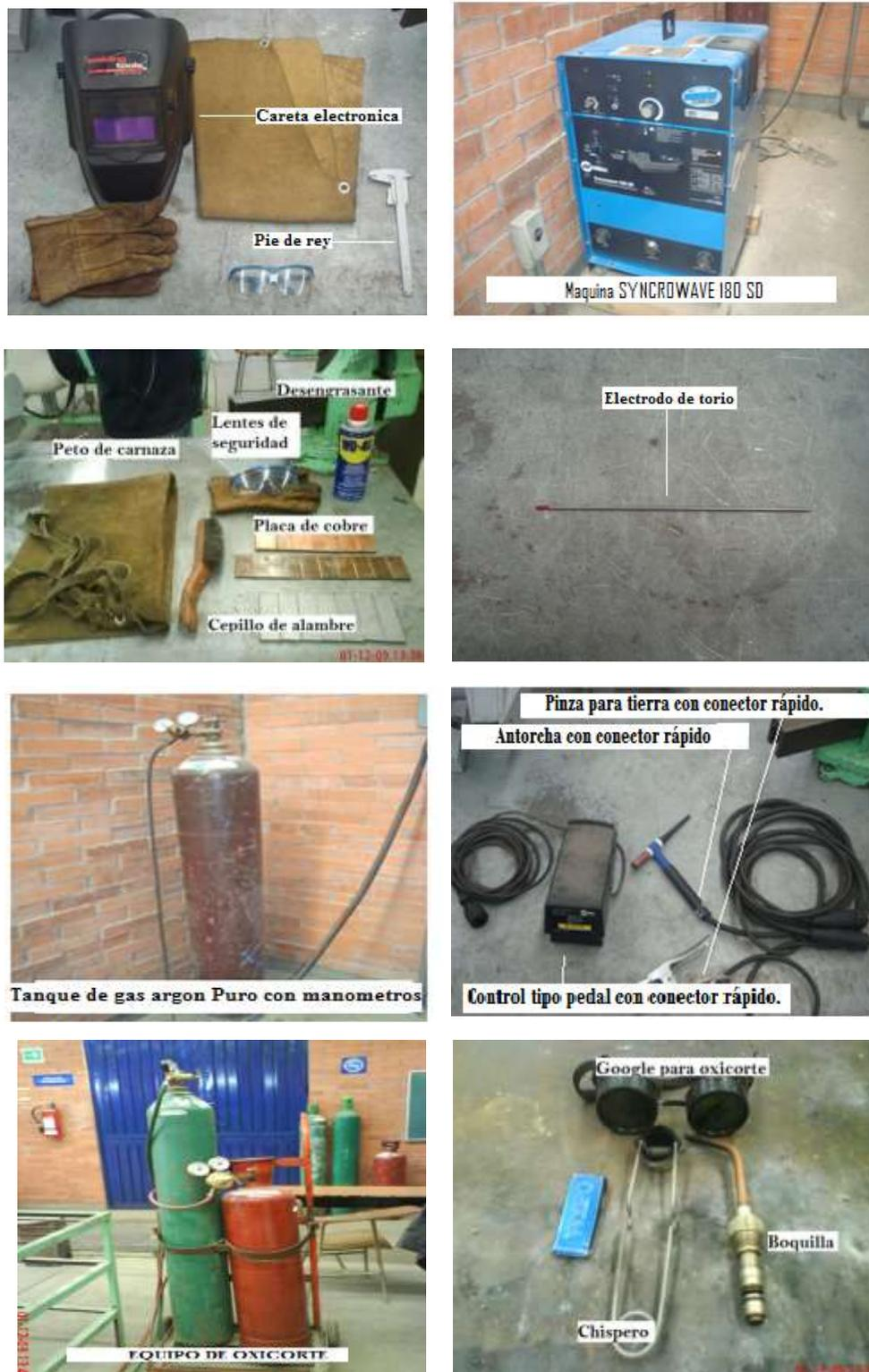
Figura 5.2 Elementos para soldadura TIG y equipo de oxiacetileno
