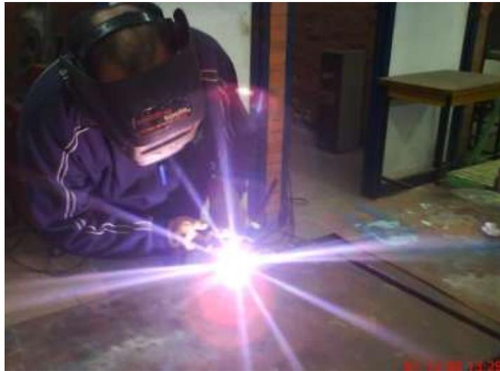
Figura 6.31 Soldando las placas de cobre
