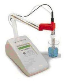
**Ajuste del aparato**. Aplicar el mismo procedimiento descrito para la calibración. Pero utilizando patrones secundarios. Esto se realiza inmediatamente antes de cada determinación.
