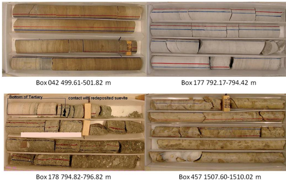
Figura 10.- La imagen de la caja de núcleos del pozo Yaxcopoli-1, representa las secciones en los carbonatos Paleógenos, la secuencia de rocas impactadas y los carbonatos del Cretácico.
