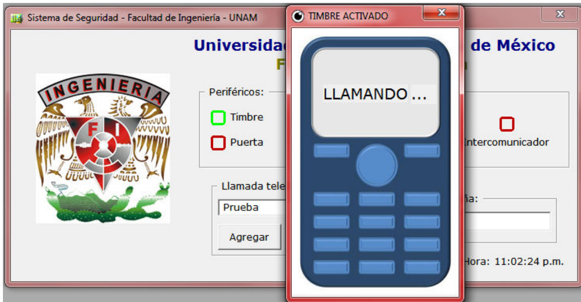
Figura 6.13. El sistema detecta la activación del timbre y realiza la llamada telefónica.
