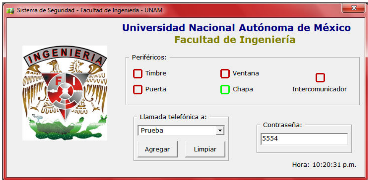
Figura 6.14. La llamada entrante se detecta, se responde y el usuario activa la chapa electrónica.
