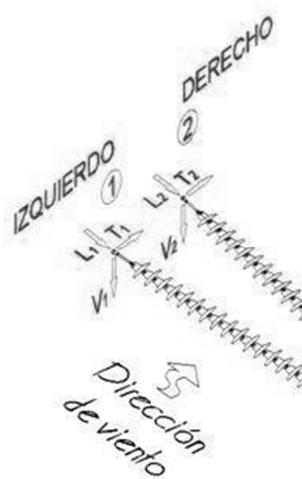
Figura 3.2 Convención para la aplicación de cargas debidas a peso de conductores y equipo.
