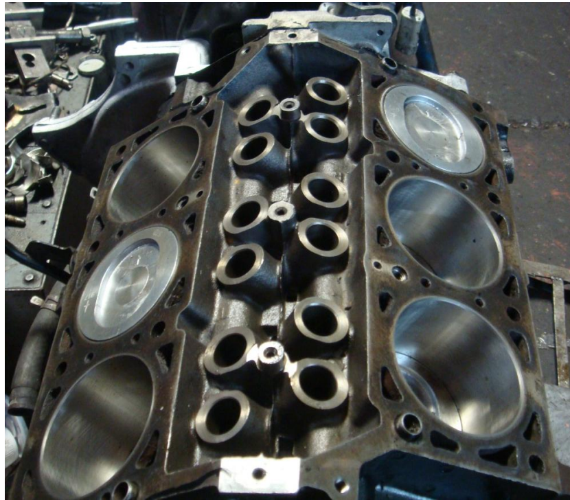
Imagen 14. Bloque (con cigüeñal, bielas, pistones, árbol de levas, distribución y tapa de distribución) de un motor Chrysler 3.8 OHV. Seis cilindros en V.
