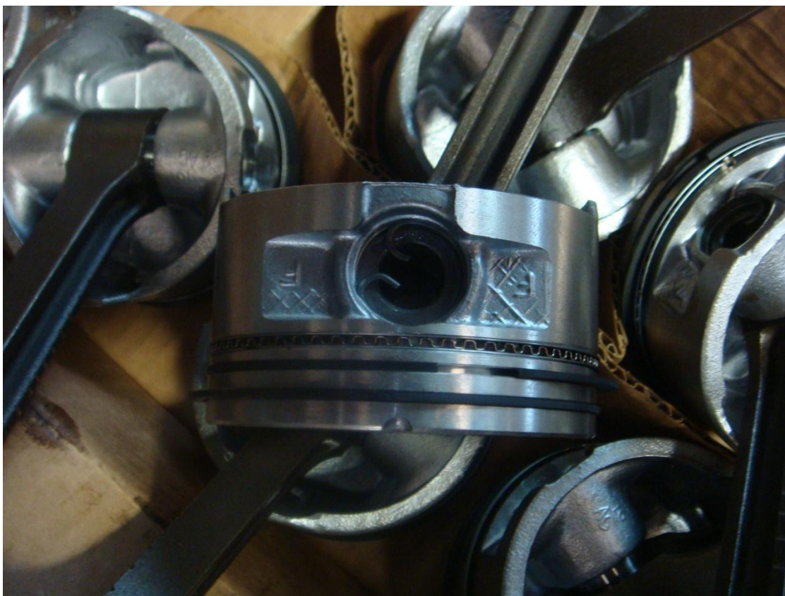
Imagen 57. Seguros para perno de pistón en un motor Ford 5.4 Litros. En este caso el pie de biela tiene buje de bronce.
