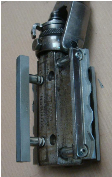
Imagen 32, 33. Juego de piedras abrasivas SUNNEN #500 para bruñir cilindros (izquierda). Al lado, herramienta insertada en uno de los cilindros de un motor Chevrolet 350 CID, OHV.
