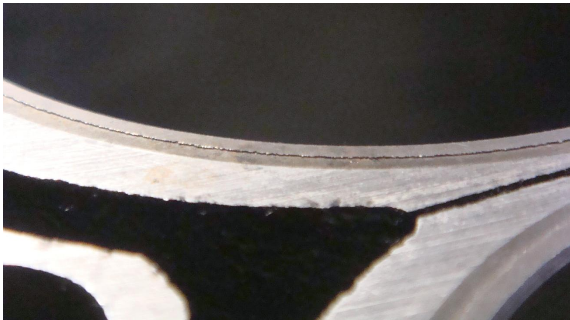
Imagen 10. Acercamiento al borde de un cilindro encamisado de un monoblock de Volvo 2.3 litros, L5. La camisa sobresale 0.005" por arriba de la superficie rectificada del monoblock.
