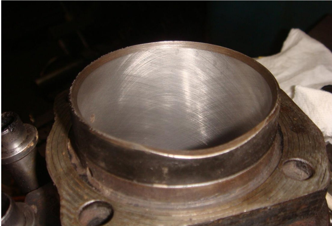
Imagen 31. Cilindro de una motocicleta BMW. La conicidad en el extremo inferior se debe a que el orden de ensamble es anillo-pistón-perno-cilindro y finalmente, biela.
