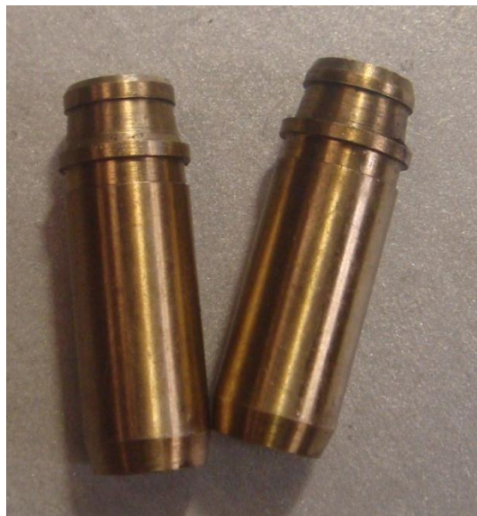
Imagen 8. Guías de válvula fabricadas en bronce, para la cabeza de un Volkswagen 1.8 litros. Se aprecia la conicidad en la parte baja, que facilita la inserción; también se ve el escalonamiento que evita que la guía descienda a mayor profundidad, y finalmente, la zona de anclaje del sello de válvula (parte superior).
