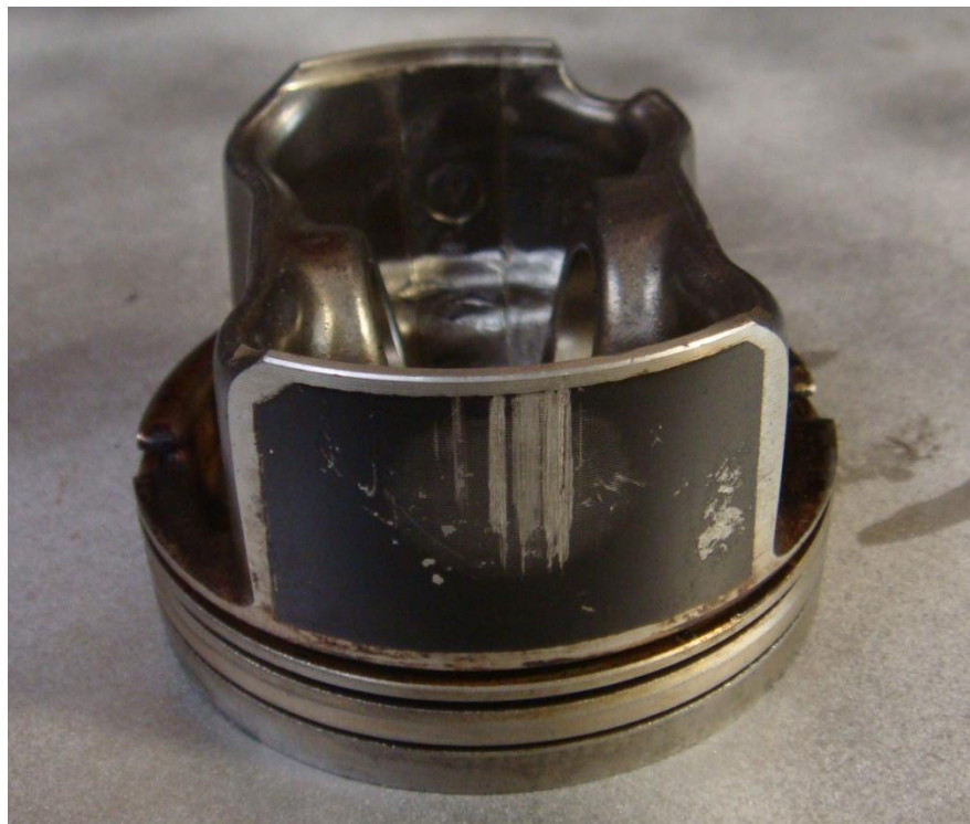
Imagen 20. Marcas de "amarre" en la falda del pistón por exceso de temperatura. La capa de teflón se rompe debido al contacto friccionante con el cilindro.
