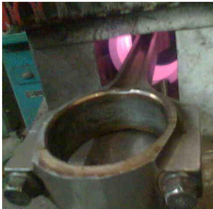
Imagen 13. Calentar el ojo de biela con resistencia eléctrica evita temperaturas excesivas.
