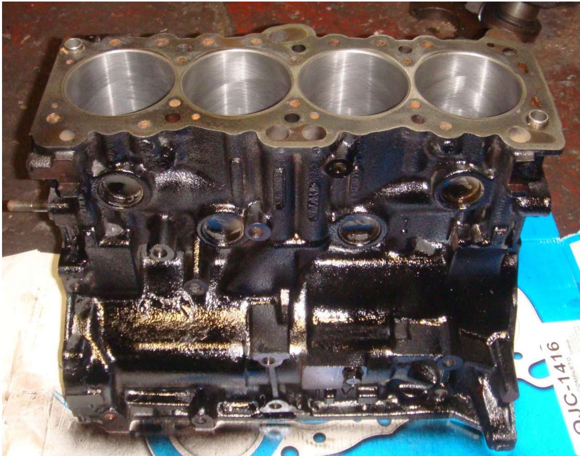
Imagen 12. Bloque de un motor Mitsubishi 4G64, 2.4 Litros, SOHC. Se aprecian los cuatro cilindros.
