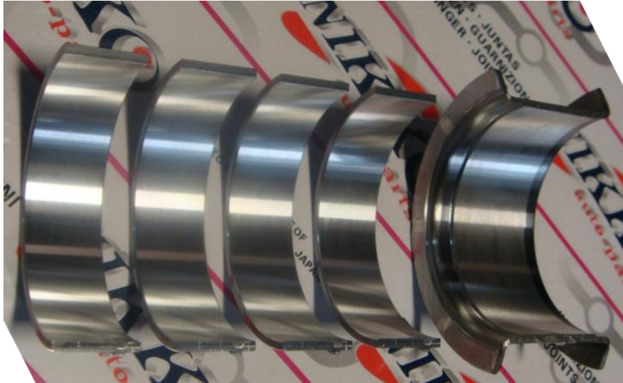
Imagen 55. Cojinetes de bancada de cigüeñal fabricados de aluminio con base acero.
