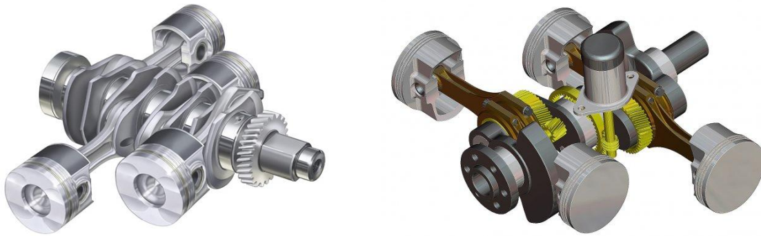
Ilustración 3. Dibujos a detalle de arreglos en bóxer (izquierda) y V a 180^\circ (derecha).
