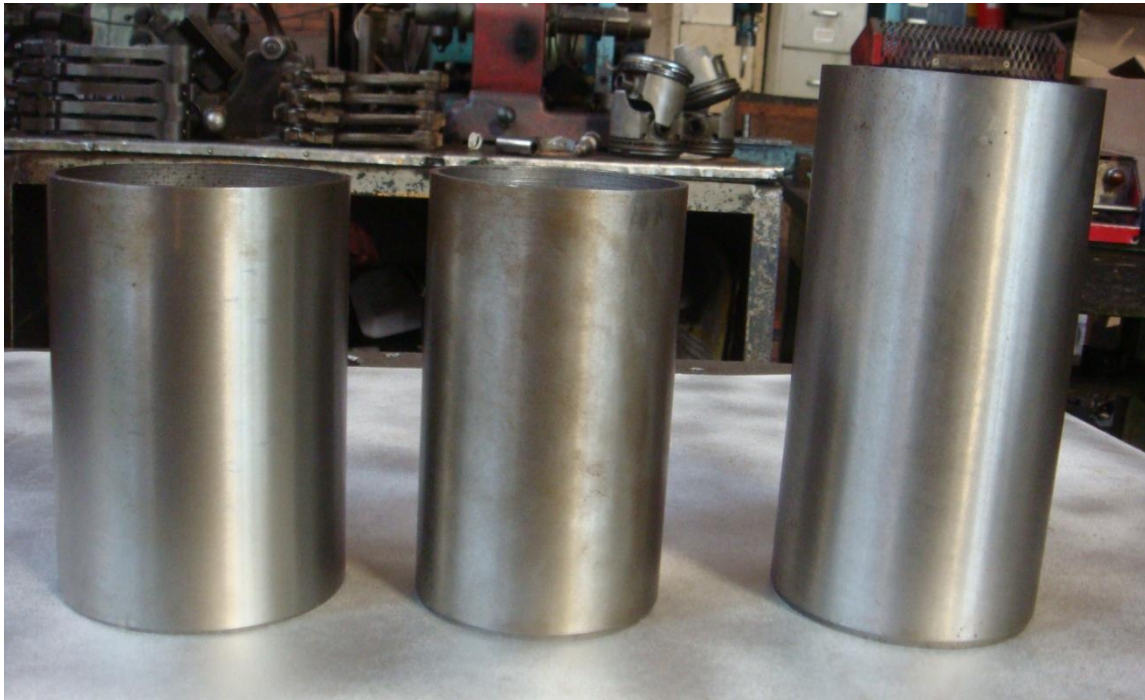
Imagen 37. Distintas camisas secas para recuperar cilindros.
