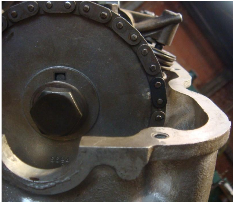
Imagen 6. Marca en la cadena de distribución, en la corona del árbol de levas y posición de éste último para sincronización del motor Nissan 2.4 Litros SOHC.
