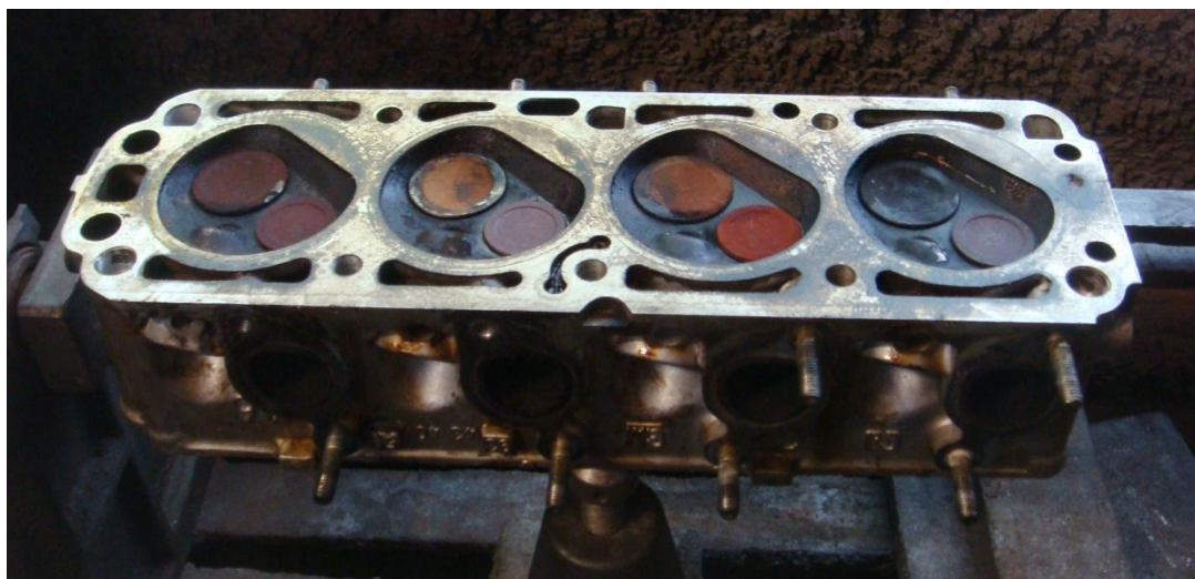
Imagen 44. Cabeza de Chevrolet 1.6 litros (Chevy) antes del rectificado de superficie.
