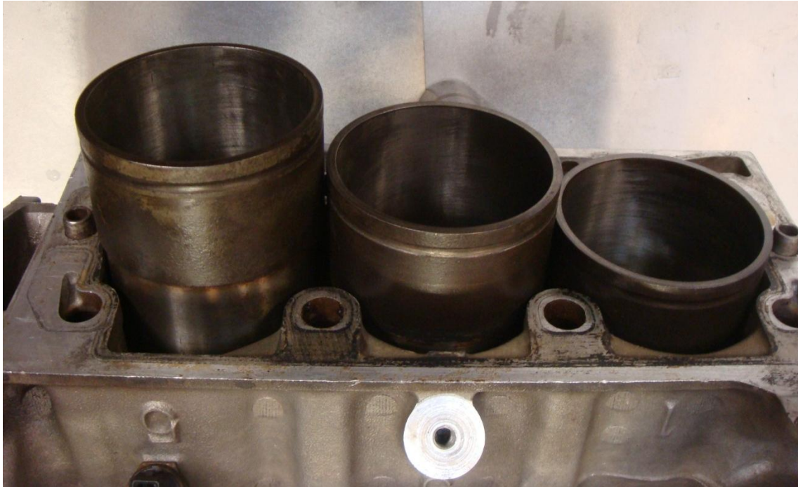
Imagen 42. Monoblock de un motor Land Rover 2.5 Litros, DOHC. las camisas son húmedas y, como se puede apreciar, postizas.
