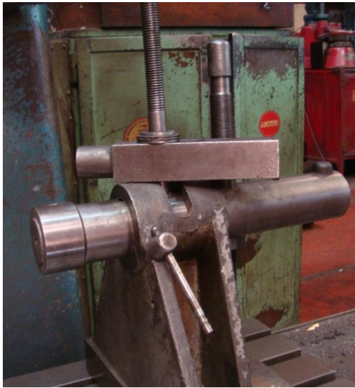
Imagen 24, 25. A la izquierda, uno de los soportes para motores en V y VR. A la derecha montado sobre los soportes, un motor Chevrolet TBI de 350 CID. Los brazos mantienen “prensado” al motor contra las ruedas de los muñones, y se colocan en los alojamientos para el árbol de levas si el arreglo es OHV.
