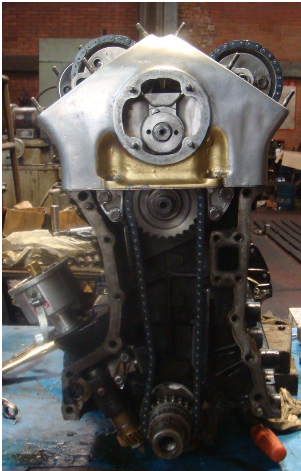
Imagen 10. Distribución de un motor Jaguar 3.8 Litros, L6, DOHC.
