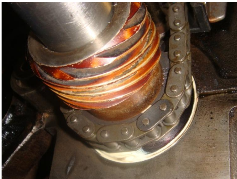
Imagen 7. Posición del cigüeñal y marcas de sincronización en la cadena y la corona para el motor Nissan 2.4 Litros SOHC.
