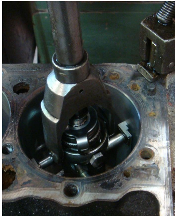
Imagen 32, 33. Juego de piedras abrasivas SUNNEN #500 para bruñir cilindros (izquierda). Al lado, herramienta insertada en uno de los cilindros de un motor Chevrolet 350 CID, OHV.
