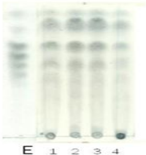
Figura 30. Perfil de productos observado mediante TLC empleando levanas de diversas fuentes después de hidrolizar. Estándar de raftilosa, hidrolizados de 1) Levana de SacB distribución bimodal 2) Levana de SacB fracción de bajo peso molecular 3) Levana de LevC 4) Levana de LevS
