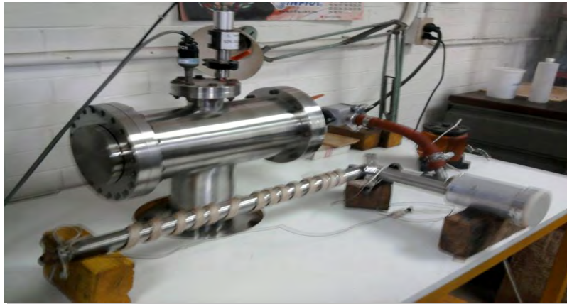
Figura III.5. Proceso de desgasificación de la zeolita.
