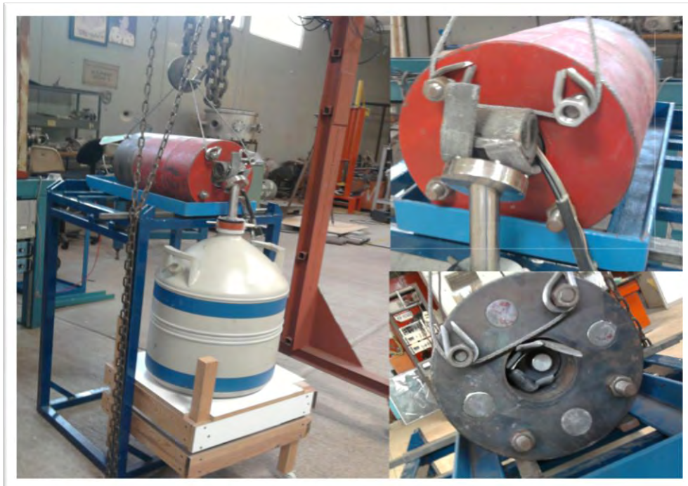
Figura III.13. Dispositivo de toma de radiación de fondo blindado, se observa el plomo con el que se taparon los orificios que estaban descubiertos.
