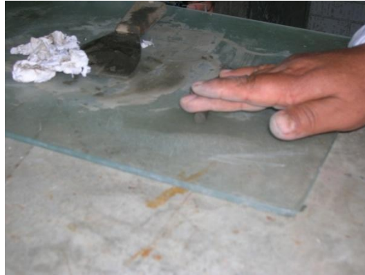
Figura 5.4. Obtención del límite plástico en laboratorio [Juárez, 2008]
