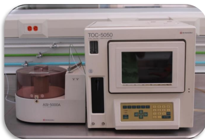
Figura 4-5. Imagen del analizador de Carbono Orgánico Total TOC-5050 SHIMADZU
