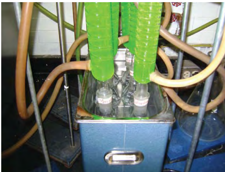
Figura 3.4. Baño de ultrasonido modificado para extracción con disolventes orgánicos
