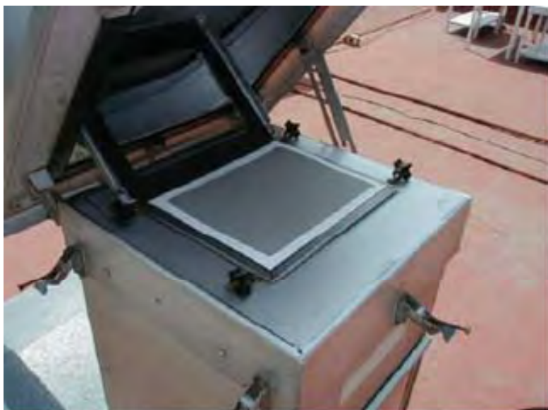
Figura 3.2. Equipo de muestreo “High-Vol” y filtro con \text{PM}_{2.5}
