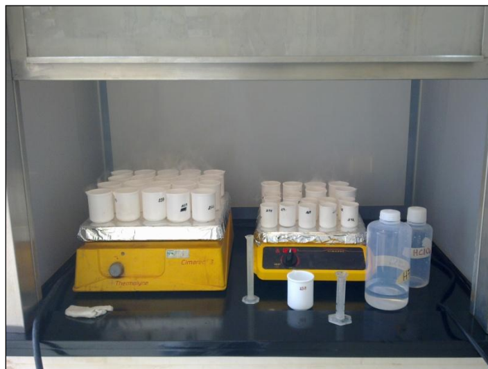
Fotografía 4.3. Digestión abierta en parilla de calentamiento.
