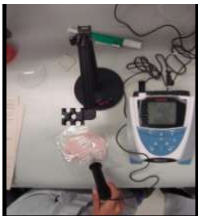
Figura 14. Prueba de pH en rebanadas de jamón de carne de conejo.
