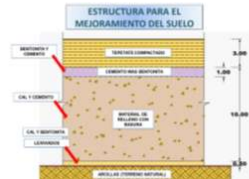
Imagen 1. Estructura para mejoramiento del suelo
