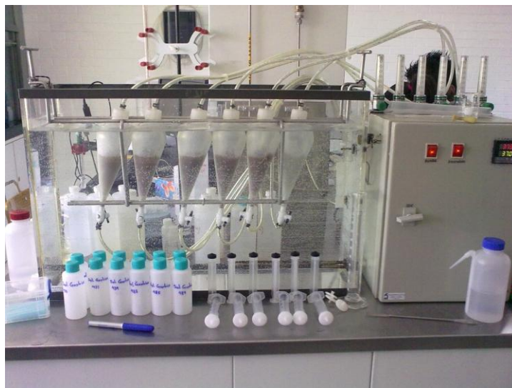
Figura 10. Fotografía del dispositivo utilizado para la determinación de la bioaccesibilidad gástrica e intestinal de As y Pb de acuerdo al método PBET propuesto por Ruby et al. (1996)
