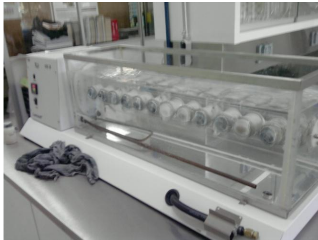
Figura 9. Fotografía del dispositivo utilizado para la determinación de la bioaccesibilidad de As y Pb de acuerdo al Apéndice Normativo “C” de la NOM-147-SEMARNAT/SSA1-2004
