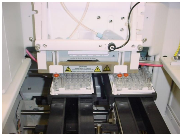
Figura 9. Vista interna del Equipo de Electroforesis Capilar, viales y capilar. Fuente: http://www.chem.sc.edu/faculty/morgan/lab.html .
