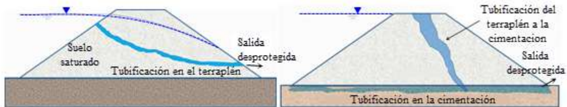
Fig. 3-16 Tipos de fallas por desarrollo de la tubificaci3n.
