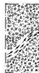
b) Erosi n por fugas
