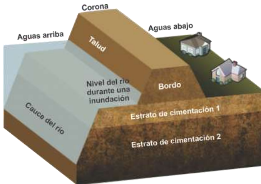
Fig. 1-14 Componentes típicos de un bordo de protección.
