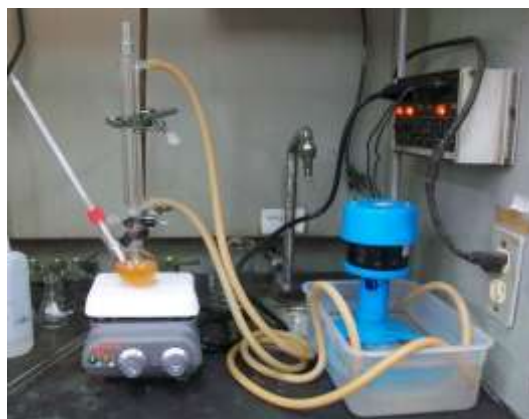
Figura 15. Equipo utilizado durante la reacción de transesterificación.
