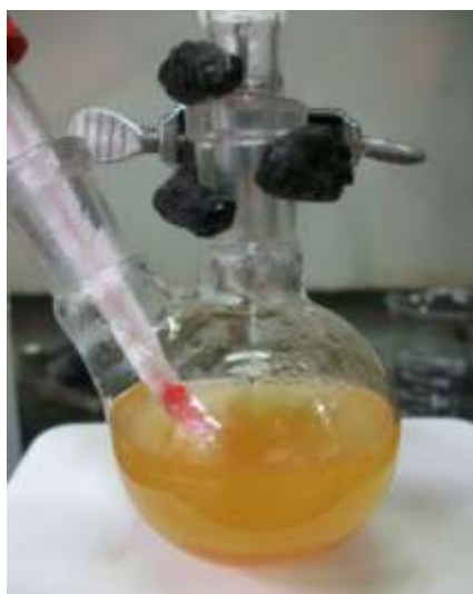
Figura 25. Aspecto de la reacción de transesterificación del aceite de A. cherimola (extraído por Soxhlet) a un tiempo de 60 min.
