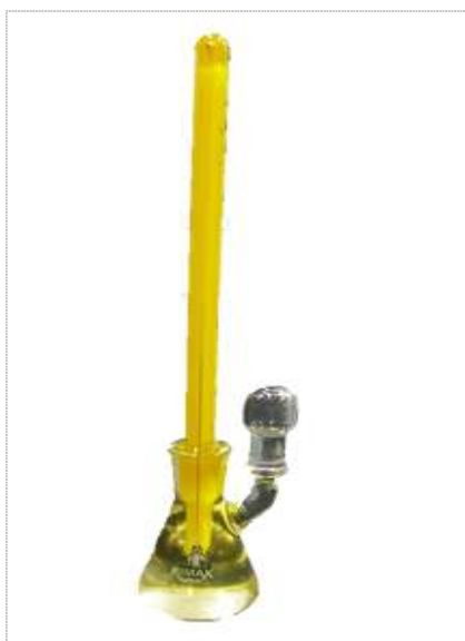
Figura 17. Medición de la densidad de aceite de A. cherimola con picnómetro.
