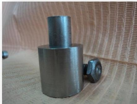
**Fig. 1 Molde de acero inoxidable para la elaboración de muestras para la prueba de abrasión. Fuente: directa.**
