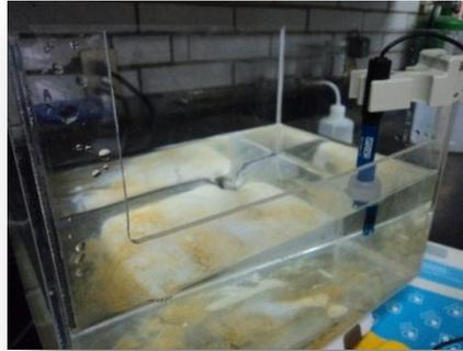
**Fig. 36** Medidor de pH en la solución de ácido láctico para ajustar ésta a un pH de  $2.7 \pm 0.01$ . Fuente: directa.
