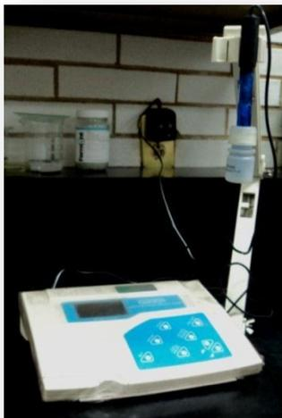
Fig.35 Medidor de potencial de hidrógeno Oakton. Fuente: directa.
