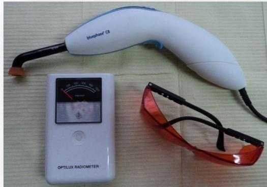
**Fig. 29** Equipo necesario para la fotopolimerización. Fuente: directa.
