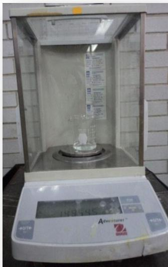
Fig. 34 Balanza analítica utilizada para pesar el ácido láctico. Fuente: directa.
