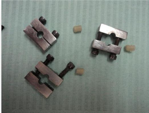
**Fig.20 Moldes de acero inoxidable para la preparación de muestras de erosión ácida, con muestras obtenidas. Fuente: directa.**
