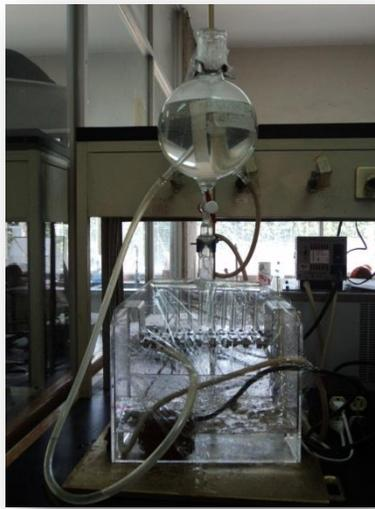
**Fig. 37** Aparato Erosionador ácido, de acuerdo a la norma 96 de la ADA.
