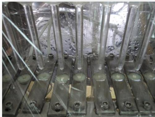
**Fig. 38** Salida del fluido sobre cada una de las muestras. Fuente: directa.
