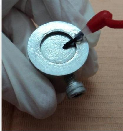
Fig. 2 Colocación de aceite de silicón en el molde. Fuente: directa.
