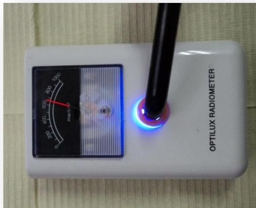
Fig. 28 Se monitoreó la intensidad de la luz de la lámpara en el radiómetro. Fuente: directa.
