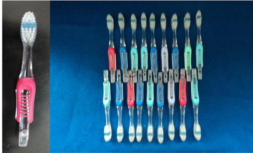
**Fig. 15 Cepillos Oral B adaptados para el aparato de abrasión. Fuente: directa.**
