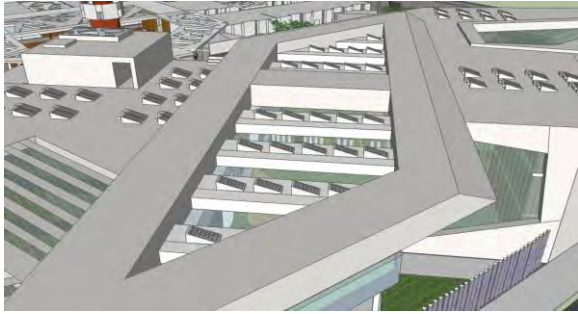
Paneles solares entre 10^\circ y 18^\circ inclinación dirigidos al sur
