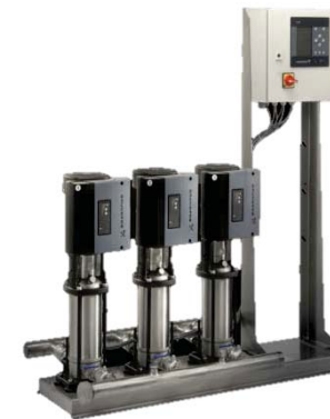
SISTEMA Hydro MPC – F MARCA GRUNDFOS, ALTURA MAX. 143 m, CON UNA CAPACIDAD DE 725 m 3 /hr, PRESIÓN MAX. 16 bar. CON TRES BOMBAS POTENCIA DE 30 Kw
