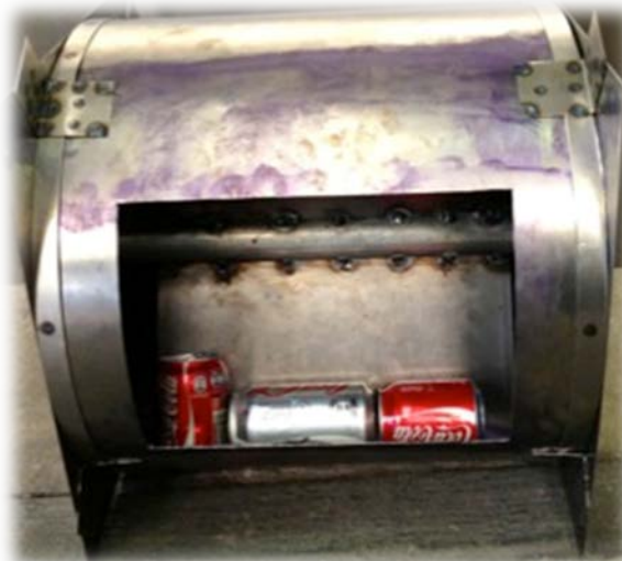
Figura 6.6 Sistema Dispensador del segundo prototipo que sirve como almacenador
