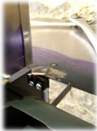
Figura 5.4 Microswitch de la puerta del Sistema de Alimentación
