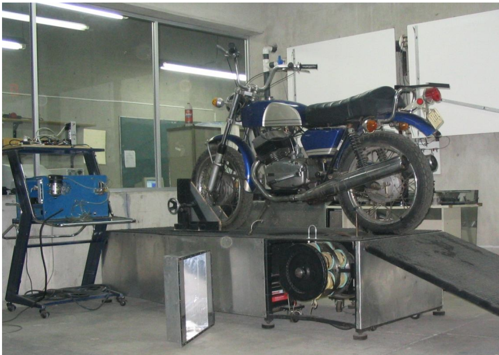
Figura 2.10 Imagen de un dinamómetro de motocicletas (2).
