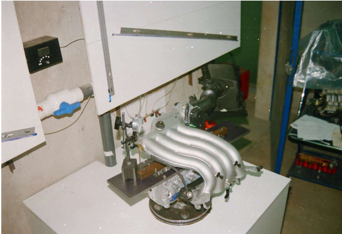
Figura 2.19 Banco de flujo desarrollado en el Laboratorio (13).
