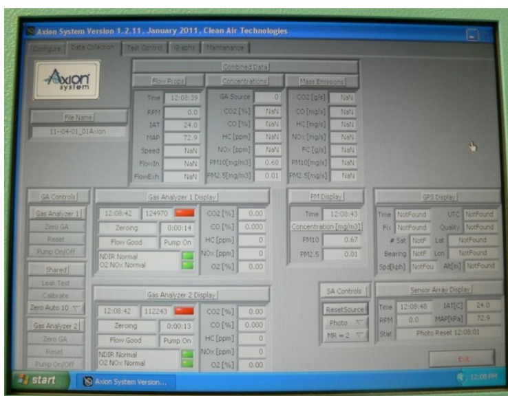
Figura 2.16 b) Imagen de archivo ampliada de la pantalla del PEMS-OEM-2100AX Axion (12).
