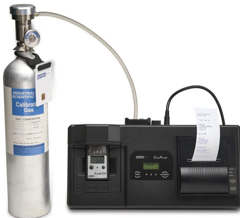
Figura 1.8 Imagen de la calibración de un equipo mediante un gas patrón.
