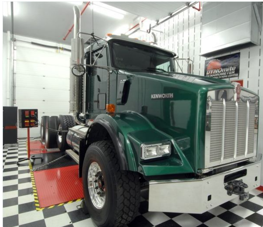
Fig. 2.8 Dinamómetro de chasis para vehículos pesados (ver anexo pág. 119 y 120)
