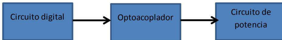
Figura 45. Acoplamiento de un circuito digital y de potencia.
