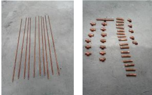
Fig. 4.8 Material de tubería y accesorios de cobre
