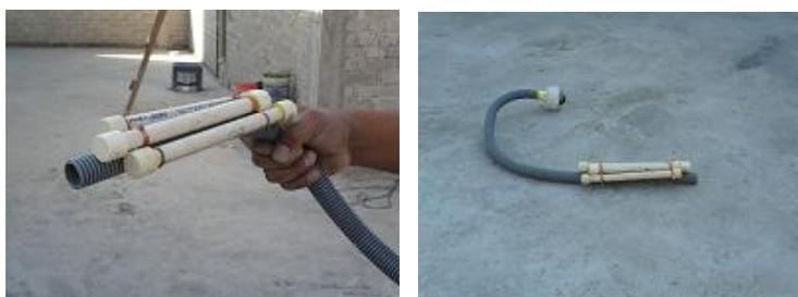
Fig. 4.49 Flotador para la manguera flexible.
