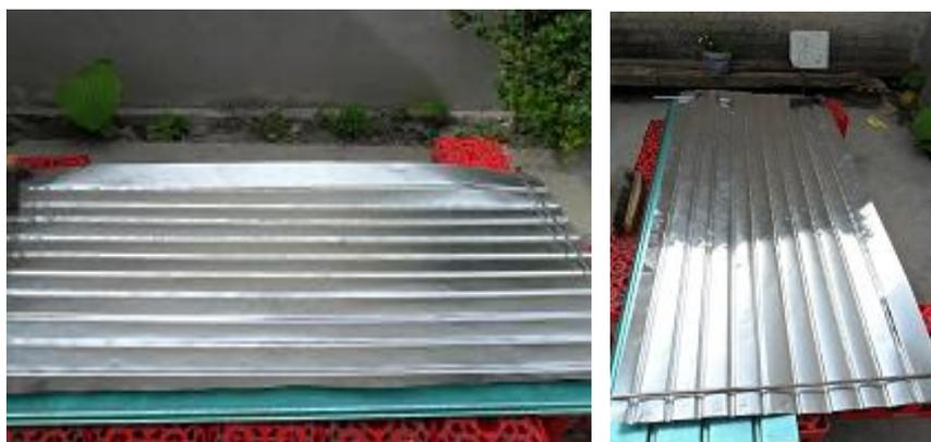
Fig. 4.21 Forjado de lámina de aluminio.
