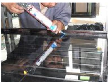
Fig. 4.35 Colocación del silicón.
