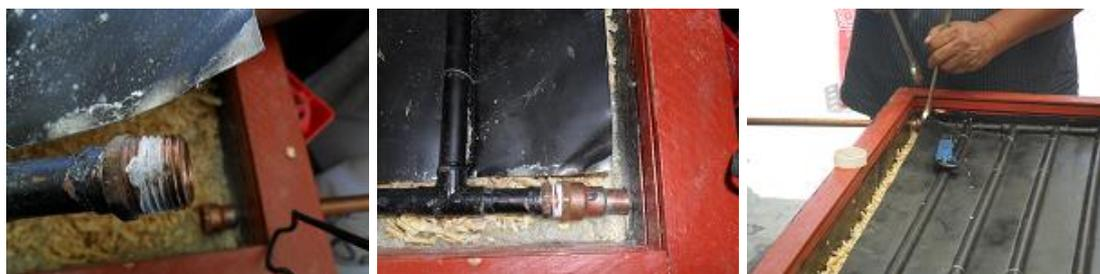
Fig. 4.32 colocación de los tubos de cobre.
