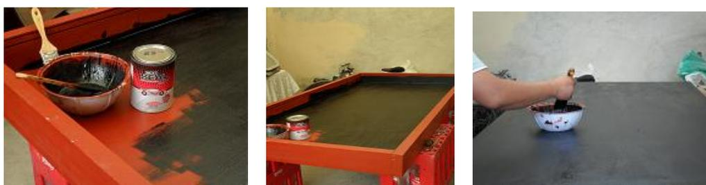
Fig. 4.28 Recubrimiento de sellador apoccil.
