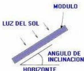
Fig. 4.4 Inclinación de un colector solar
